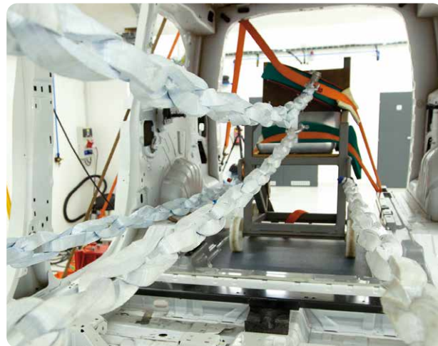
Zugversuche zur Prüfung der Rollstuhlverankerungen im Fahrzeug.
