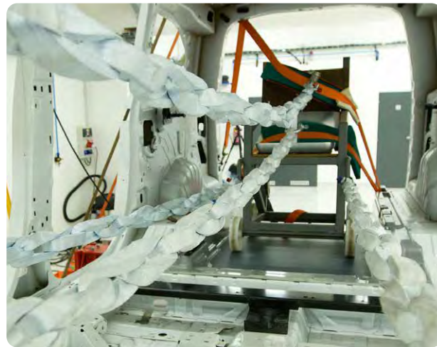
Zugversuche zur Prüfung der Rollstuhlverankerungen im Fahrzeug.
