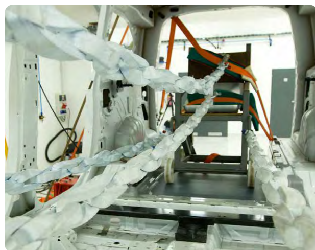
Essais de traction pour les ancrages de fauteuil roulant dans le véhicule
